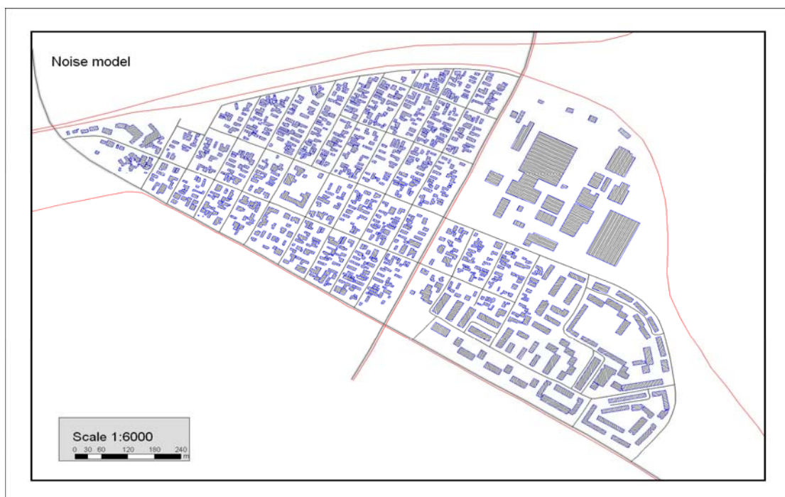
Fig. 11. Harta tematică finală (2D) – HARTA DE BAZĂ care se utilizează pentru modelarea zgomotului (Obținută prin suprapunerea hărților tematiche de la Fig. 7-10)
